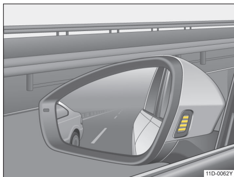
图 108 车外后视镜外壳内：变道辅助系统的可视显示
